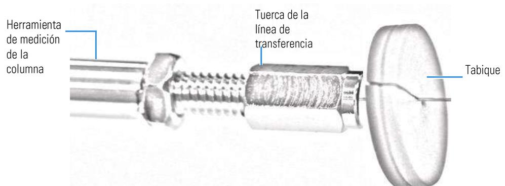
14. Tire la columna hacia atrás desde la tuerca de la línea de transferencia. No mueva el septum de su posición en la columna.
