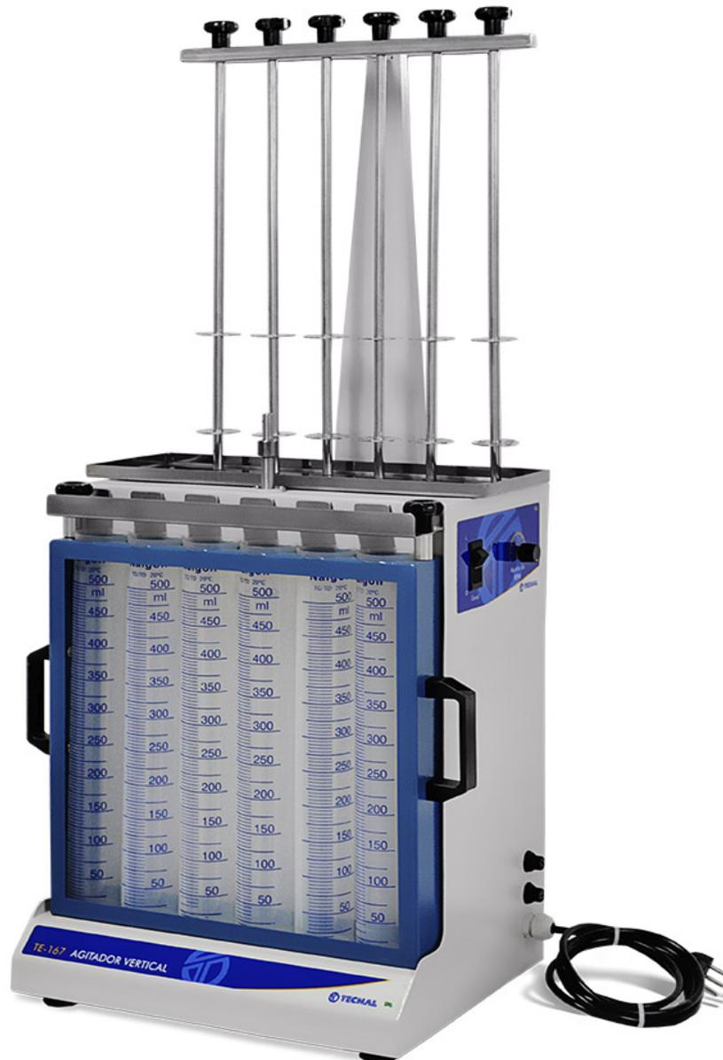
Utilizado para análisis física del suelo, para medición de la granulometría a través de su densidad. Homogeneiza las muestras preparadas en el TE-161 permitiendo la medición en el densímetro Boyoucos.
