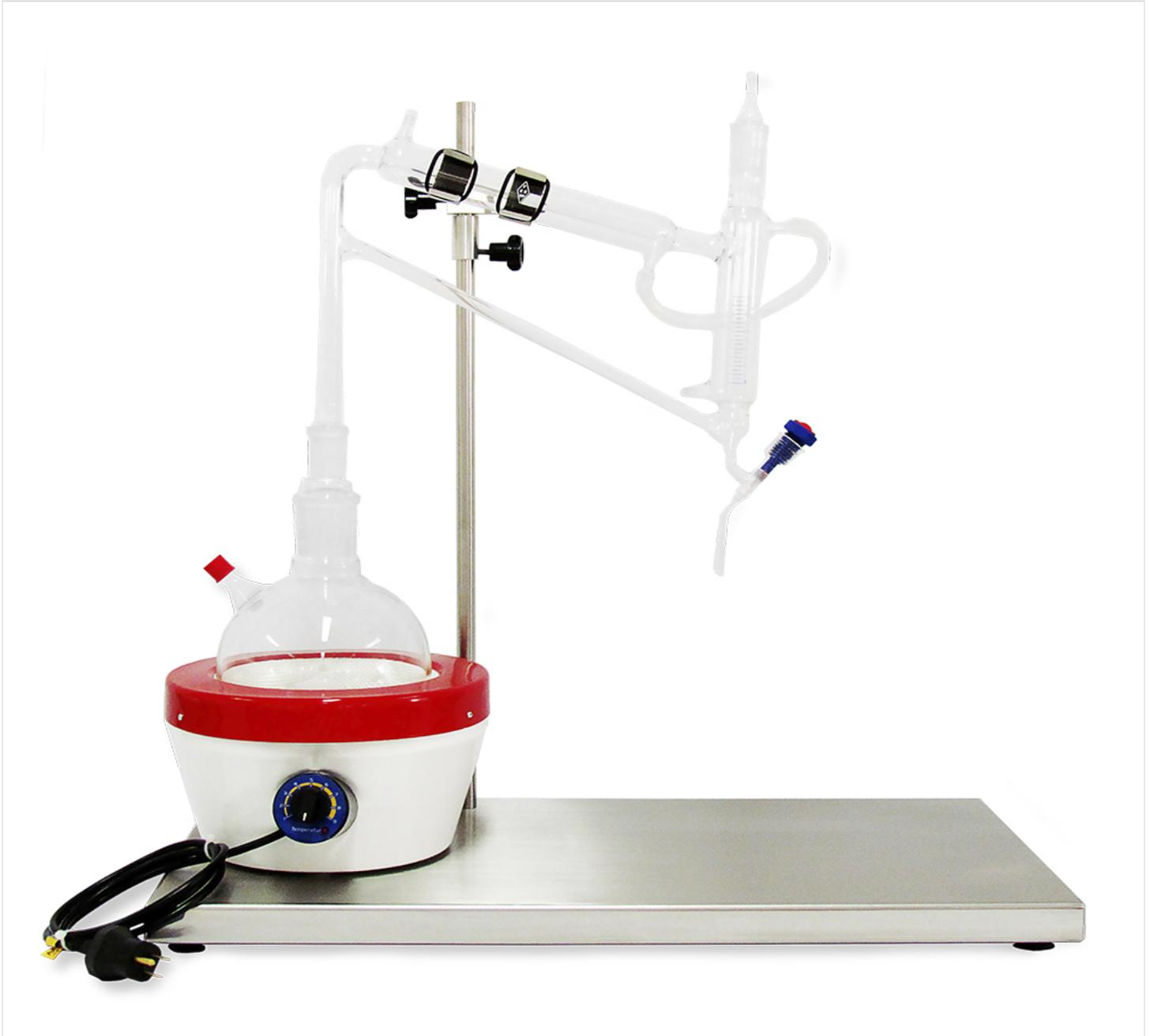
Utilizado para extracción de volumen pequeño para aceites esenciales volátiles menos pesados que el agua y extracción indirecta por arrastre del vapor. Indicado para pruebas preliminares y pequeñas producciones para la investigación.
