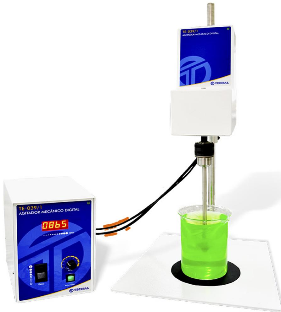
Utilizado para agitación mecánica en fluidos, líquidos de alta viscosidad y material en suspensión
