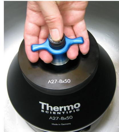
**Figura 14.** Posición de las manos en el desmontaje del rotor
